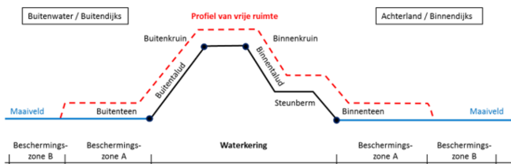
Figuur 18.2: Principe van leggerprofiel en bijbehorende beperkingengebieden/zones en profiel van vrije ruimte
