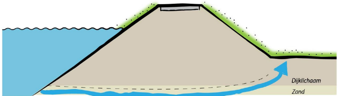
Figuur 3.3 Faalmechanisme Piping
