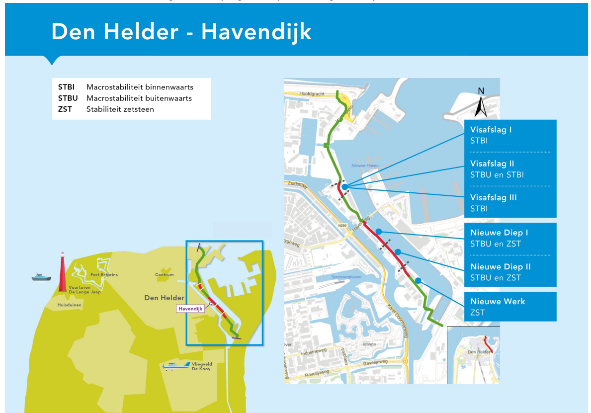
Figuur 2.1 Projectgebied dijkversterking Havendijk Den Helder
