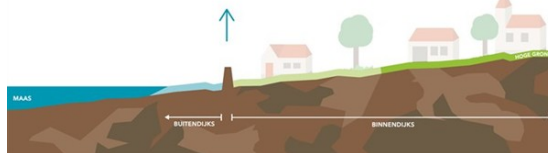
Figuur 10.2 schematische weergave dijkversterking en nieuw binnendijks gebied
