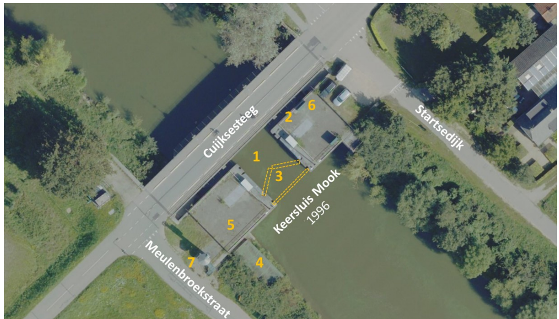
Figuur 2 2: Situatieschets rondom de keersluis: 1) sluisolk, 2) sluiswanden, 3) puntdeuren, 4) opslag schotbalken, 5) sluisplateau / kistdam 6) bedieningskast, 7) voormalige heftoren / uitzichtpunt
