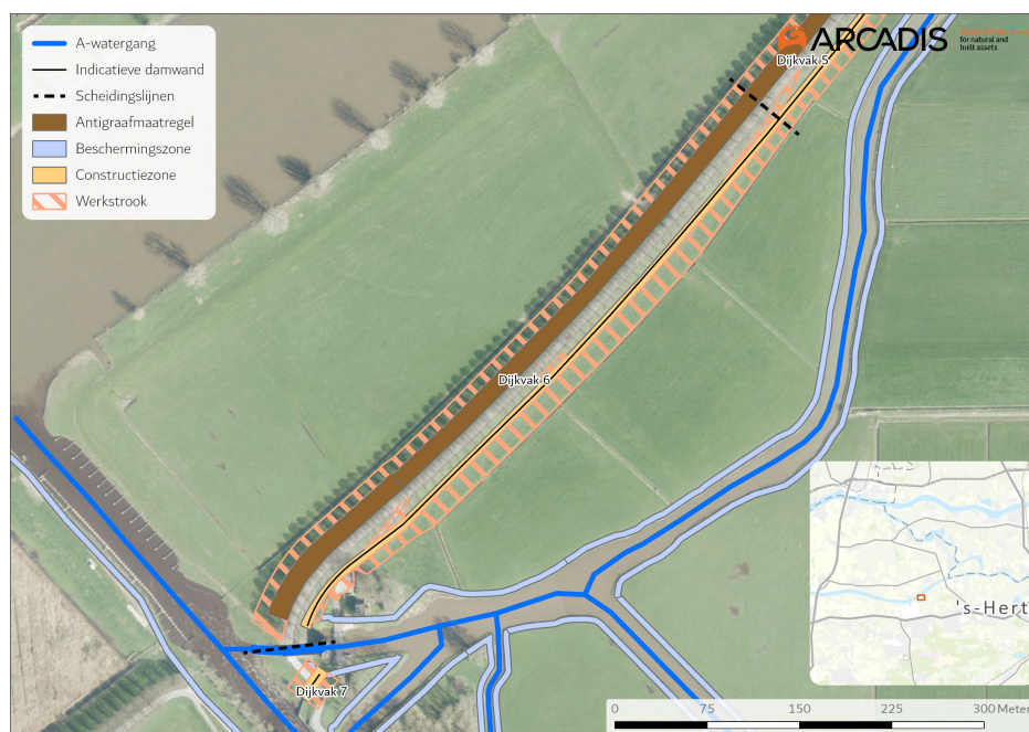
Dijkverbetering Doeveren met (beschermingszone) A-watergang dijkvak 6
