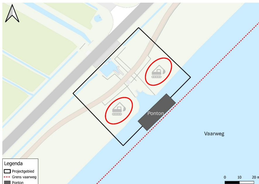
Figuur 7.4: globale positie kraan en ponton ten opzichte van de waterkant en de vaarweg
