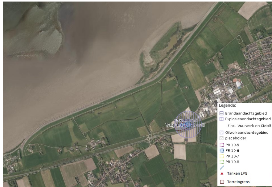
Afbeelding 6.1 Ligging plaatsgebonden risicocontour en aandachtsgebieden Tankstation TotalEnergies
