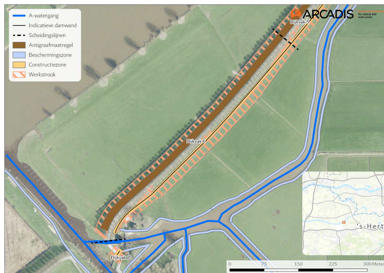
Dijkverbetering Doeveren met (beschermingszone) A-watergang dijkvak 6
