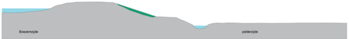
Figuur 5 Voorbeeld taludverflauwing
