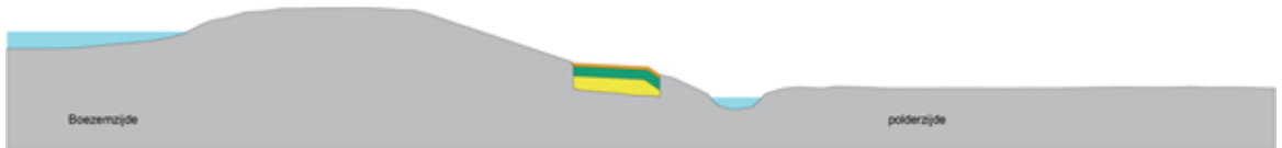
Figuur 6 Voorbeeld grondverbetering
