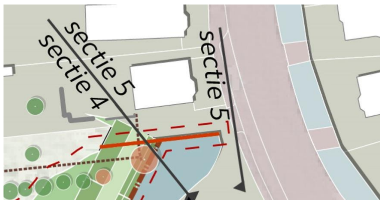
Figuur 135 Overzicht sectie 5. De rode dikke streep is de locatie van het waterkerende muurtje.
