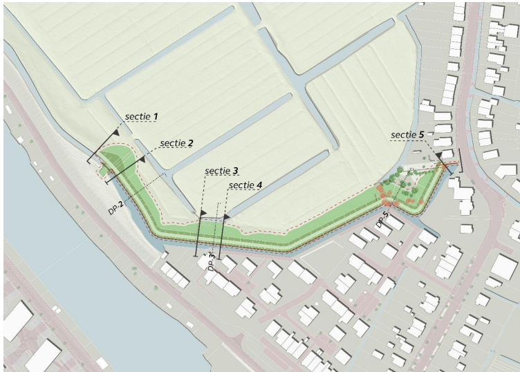
Figuur 3 Projectgebied Wilmkebreekpolder. De grenzen van de verschillende secties zijn weergegeven. Ook zijn locaties van dwarsprofielen (DP-2, DP-3 en DP5) die later in dit plan aan bod komen weergegeven.
