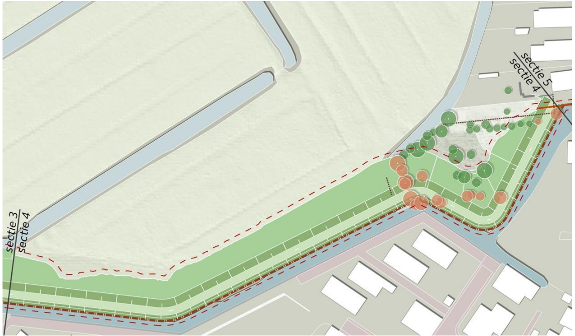
Figuur 113 Overzicht van sectie 4. De ronde vormen zijn bestaande bosschages. Indien ze rood zijn weergegeven dienen ze voor de versterking verwijderd te worden. Groen weergegeven vegetatie kan blijven staan.
