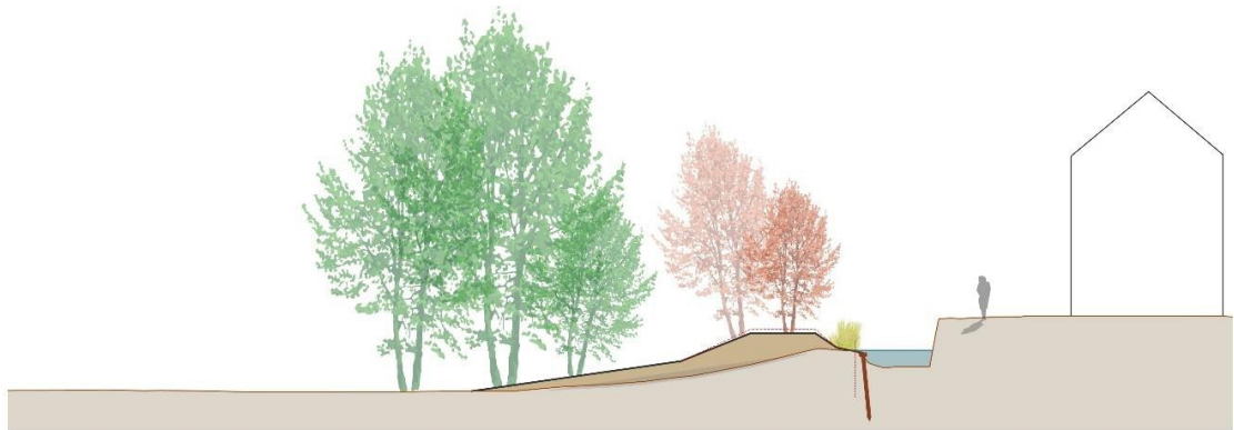
Figuur 113 Overzicht van sectie 4. De ronde vormen zijn bestaande bosschages. Indien ze rood zijn weergegeven dienen ze voor de versterking verwijderd te worden. Groen weergegeven vegetatie kan blijven staan.
