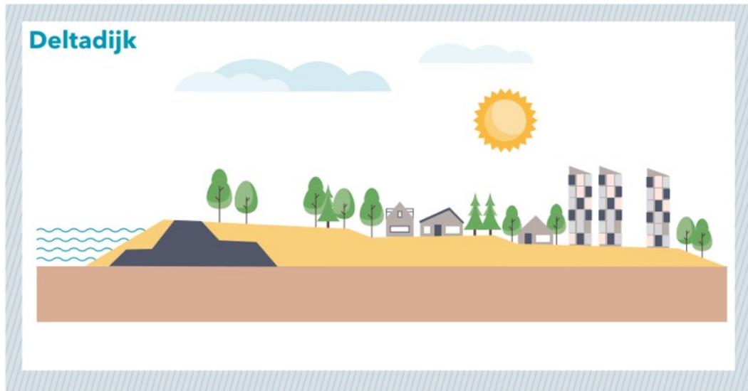
Figuur 16: Schematische weergave van het concept van de deltadijk.
