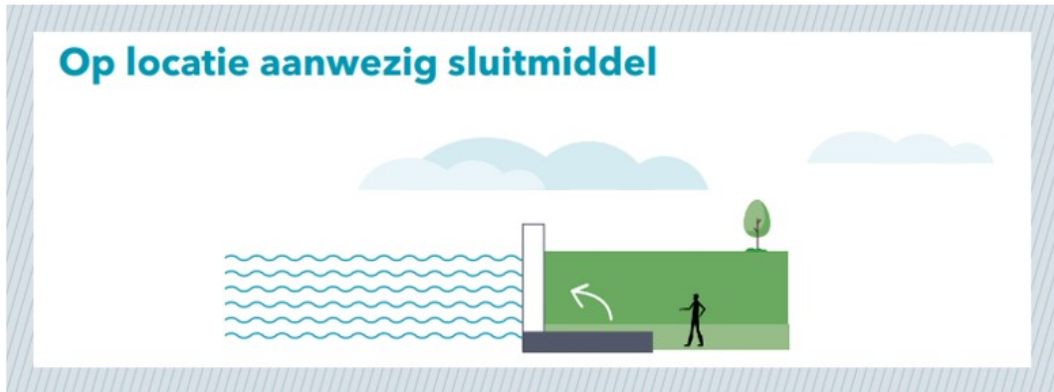
Figuur 14: Schematische weergave van een waterkering met een op locatie aanwezig sluitmiddel.
