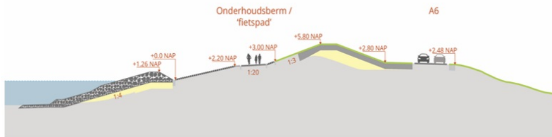
Figuur 5-4: Dwarsdoorsnede van het referentieontwerp op het traject Meerdijk-Midden
