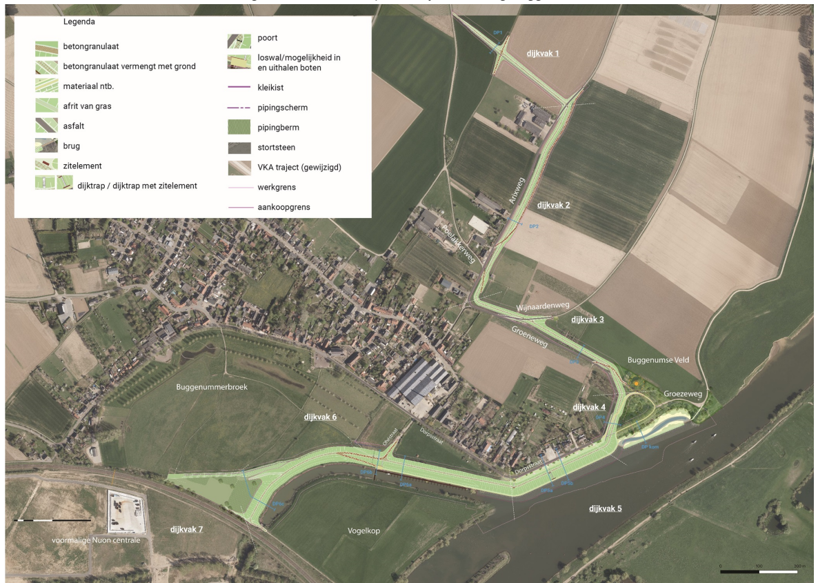
Figuur 4.1: DO-ontwerp voor dijkversterking Buggenum
