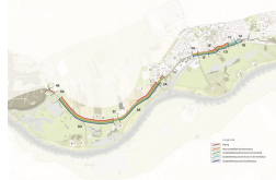
Afbeelding 1.6 Belangrijkste faalmechanismen Grebbedijk per dijkvak
