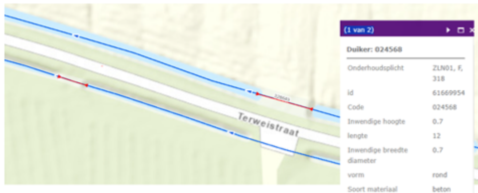
Figuur 2.2b: Het waterstaatswerk duiker. Op onze legger wateren staan ruim 30.000 duikers.
