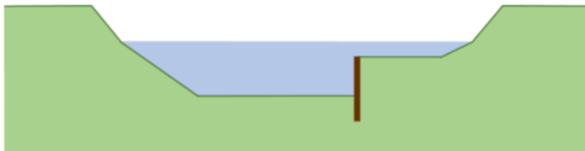
Figuur 2. Voorbeeld van NEZ met onderwaterbeschoeiing om ingroeien van planten in de watergang te voorkomen.
