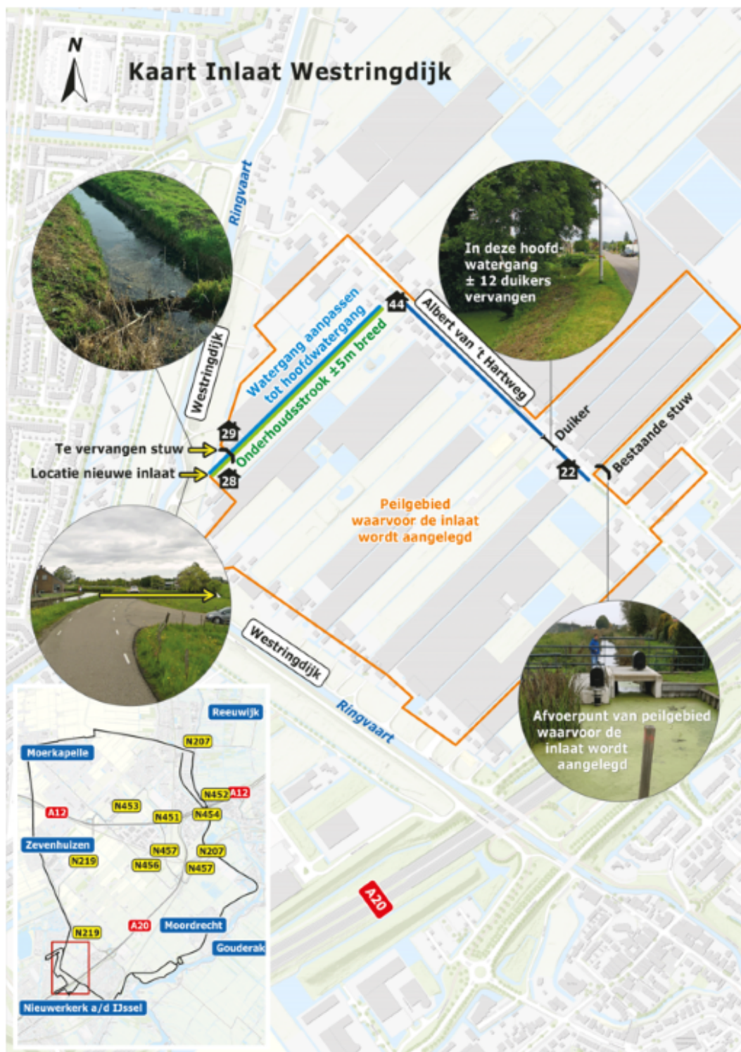
Figuur 1: Inlaat Westringdijk
