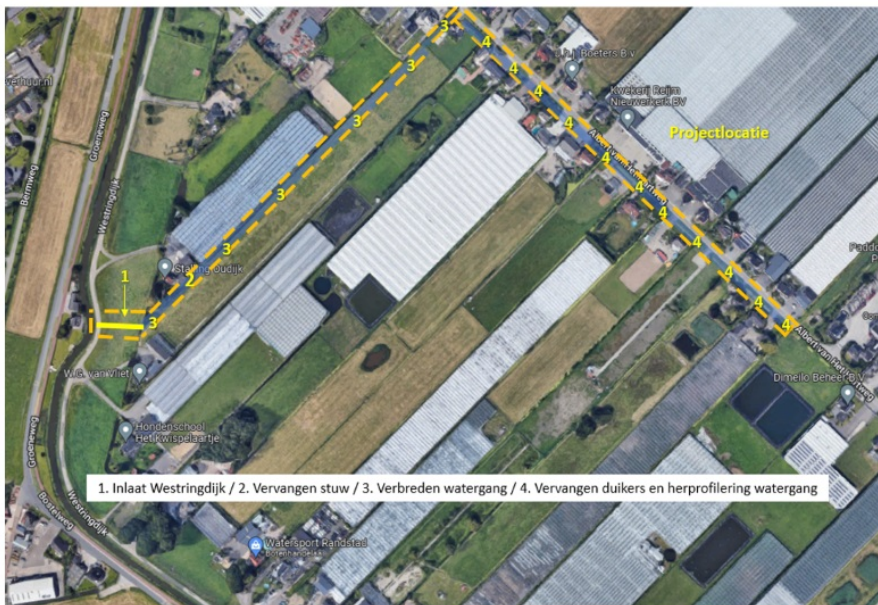
Afbeelding 2: Onderdelen project: Inlaat Westringdijk
