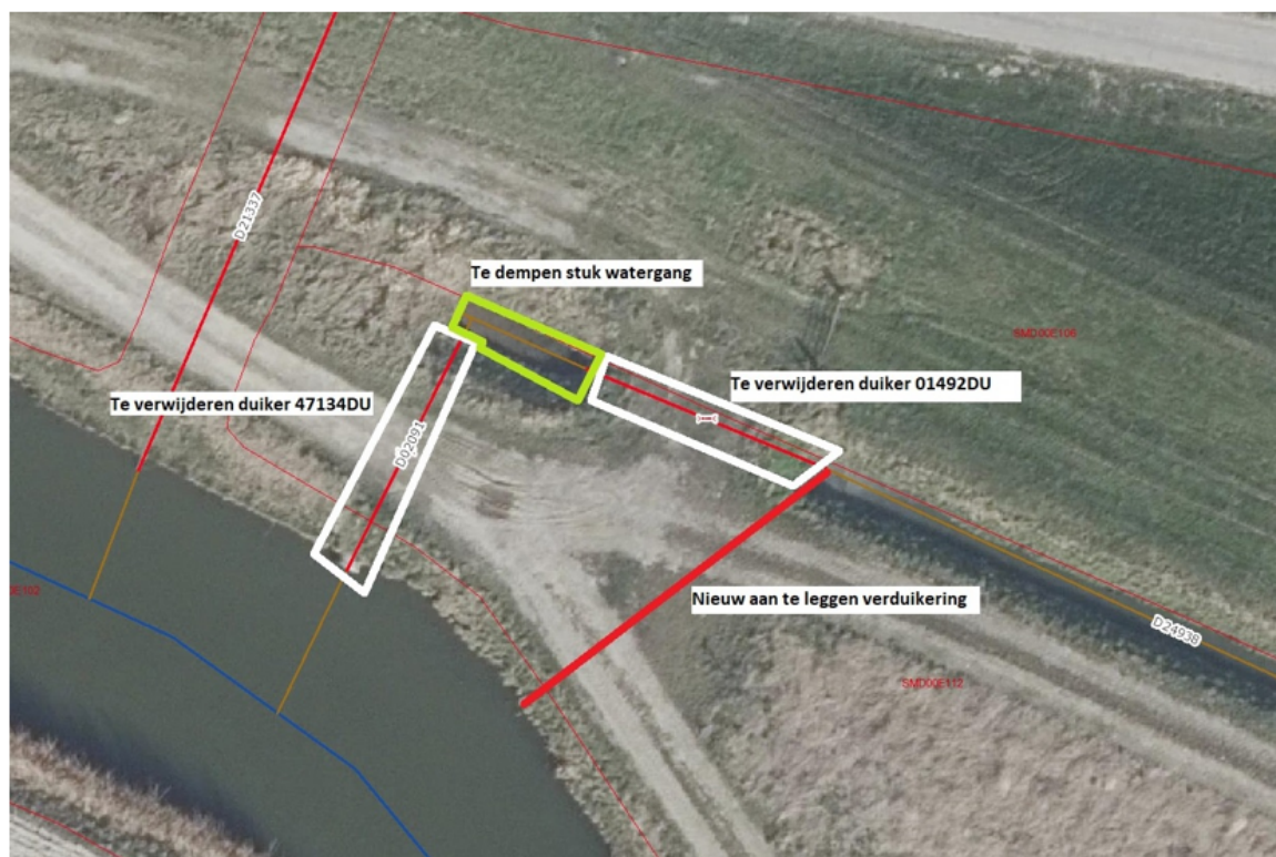
Figuur 3: Werkzaamheden optimalisatie aan- en afvoer dijksloot D24938 (detail).
