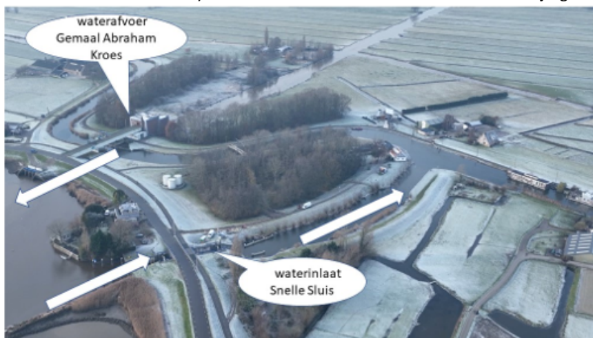
Figuur 3. Luchtfoto van de Ringvaart bij gemaal Abraham Kroes en Snelle Sluis met stroomrichting bij waterafvoer naar en waterinlaat uit de Hollandse IJssel (linksonder).
