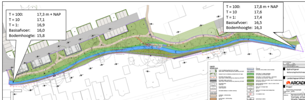
Figuur 5.3: Nieuwe waterpeilen en bodemhoogten in de watergang
