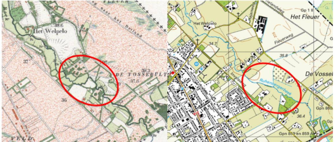
Figuur 2.4 Voorbeeld van meandering omstreeks 1900 benedenstrooms van de Ficksweg die later is genormaliseerd
