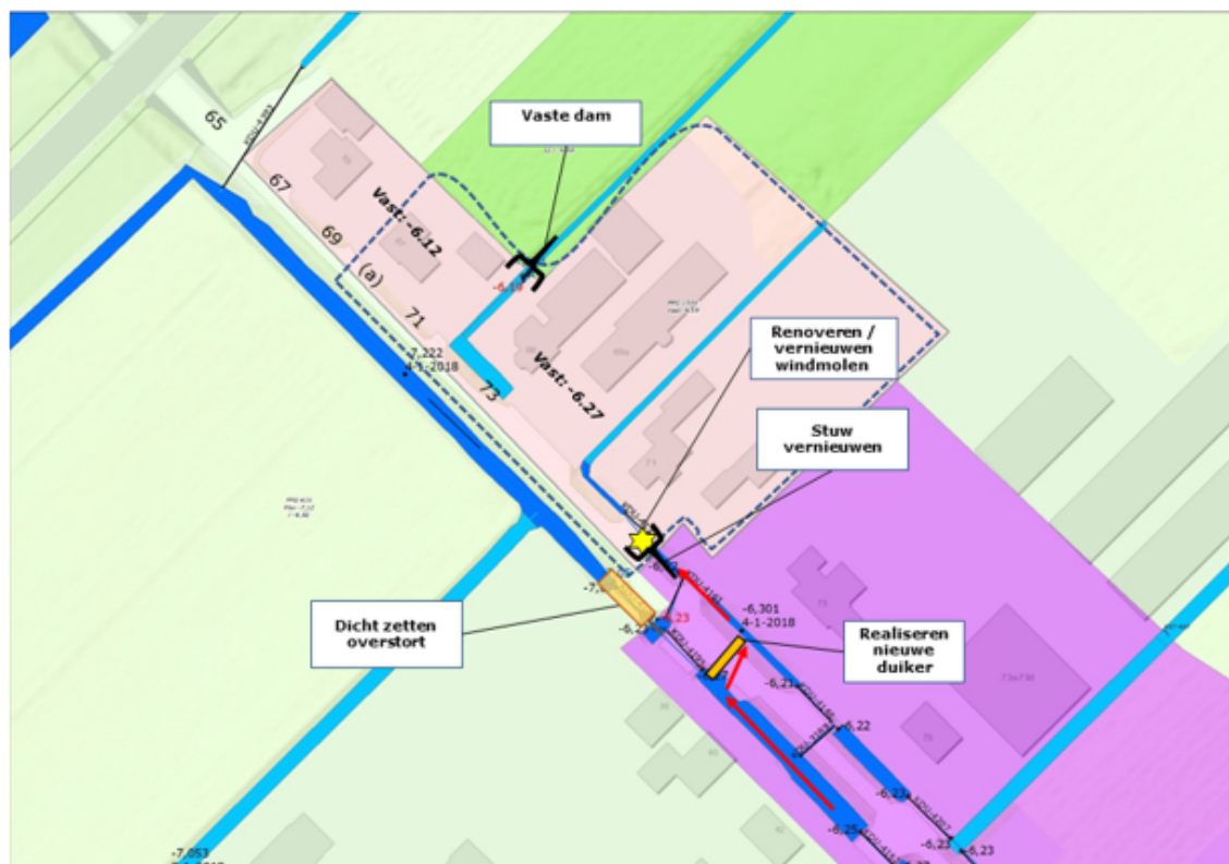
Figuur 7: Overzichtstekening werkzaamheden project Peilopzet voorzieningen Knibbelweg
