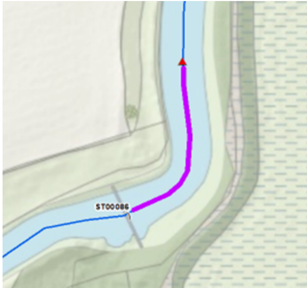
Figuur 2: Traject waar peilverhoging optreedt door verplaatsing van stuw (paars).
