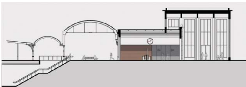
Figuur 16 Dwarsdoorsnede stationshal
