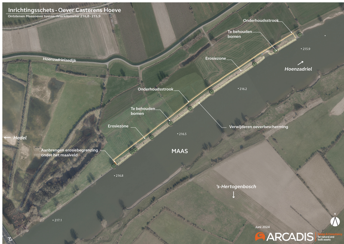
Figuur 7 Inrichtingsschets oever Casterens Hoeve
