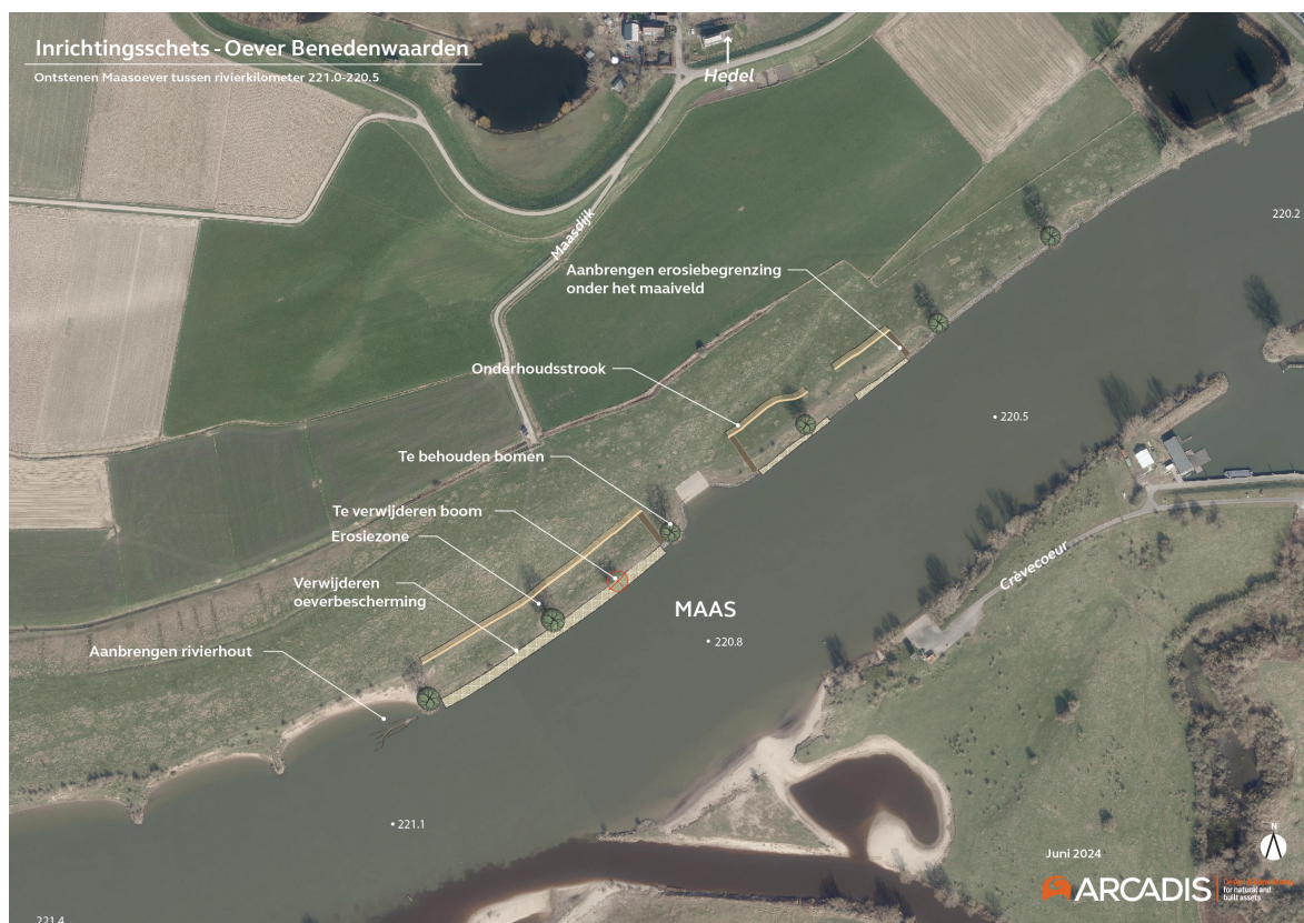
Figuur 6 Inrichtingsschets van de maatregel oever Benedenwaarden
