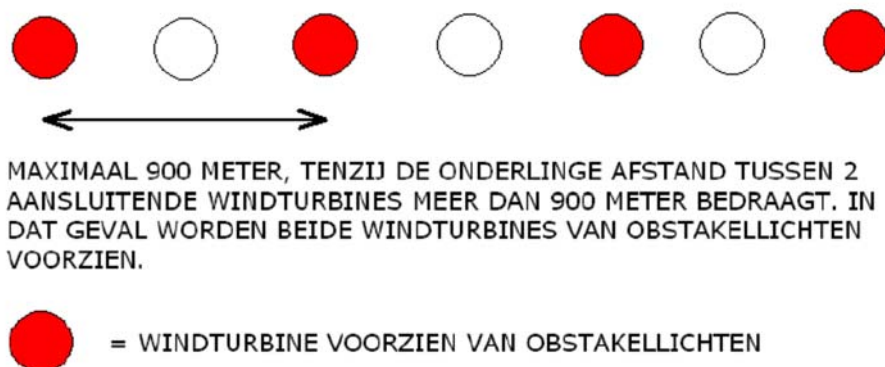
Figuur V – 2 Windturbines te voorzien van obstakellichten in een lijnopstelling
