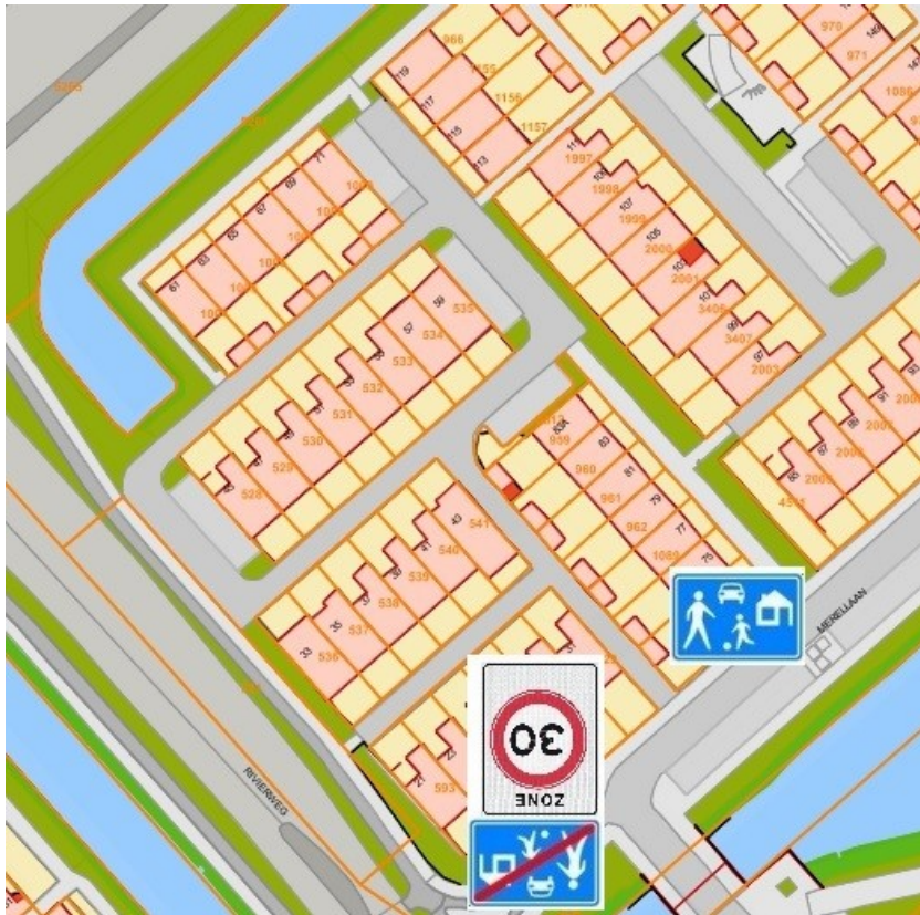
Figuur 1: aanbrengen bebording Merellaan 21-83a (oneven nummers)
