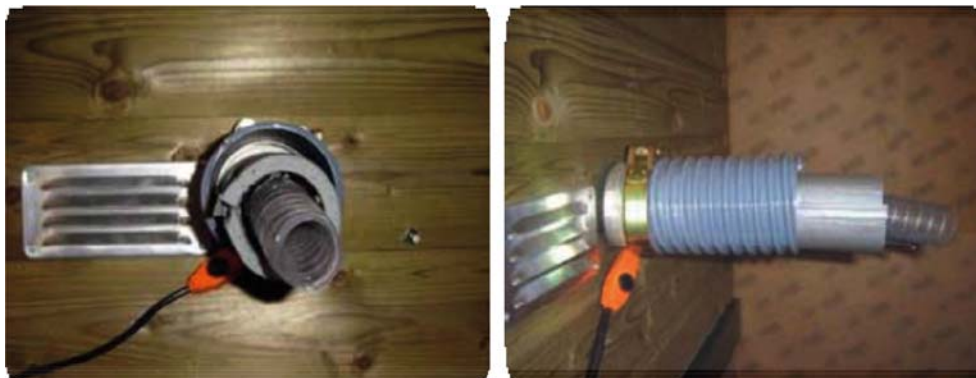
Schematische weergave (boven); walslang met verwarmingslint buiten de slang: vooraanzicht (linksonder) en zijaanzicht (rechtsonder)
