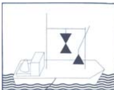
Artikel 3.37, lid 2: Visserschip dat zonder treil vist en waarvan het vistuig meer dan 150 m in zee uitstaat.
