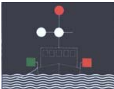
Artikel 3.37, lid 2: Visserschip dat zonder treil vist en waarvan het vistuig meer dan 150 m in zee uitstaat.
