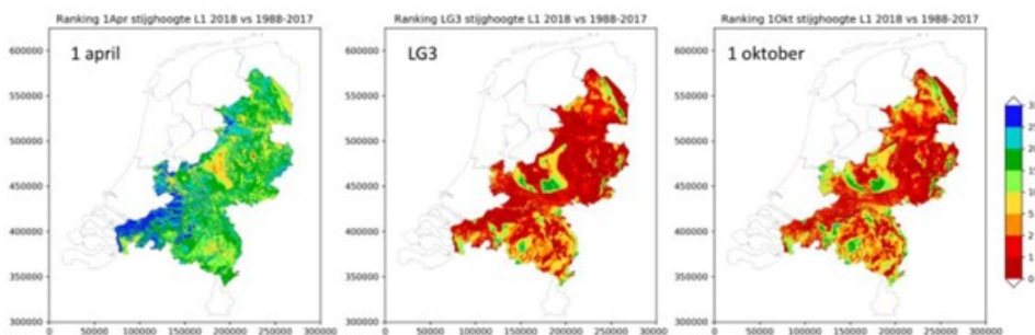
Figuur 11. LHM-resultaten: de ranking van de grondwaterstand in 2018 t.o.v. de afgelopen 31 jaar. Ranking 1 (rood) betekent de laagste grondwaterstand t.o.v. de afgelopen 30 jaar, ranking 31 (blauw) de natste. Overgenomen van (Van den Eertwegh et al., 2019). LHM = het landelijk hydrologisch model.
