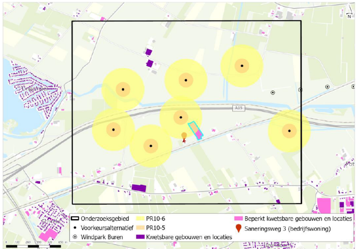
Afbeelding 5.40 (beperkt) kwetsbare gebouwen en locaties nabij windturbines (bovengrens) (blauw omlijnd is ijsclub de Hoeken)
