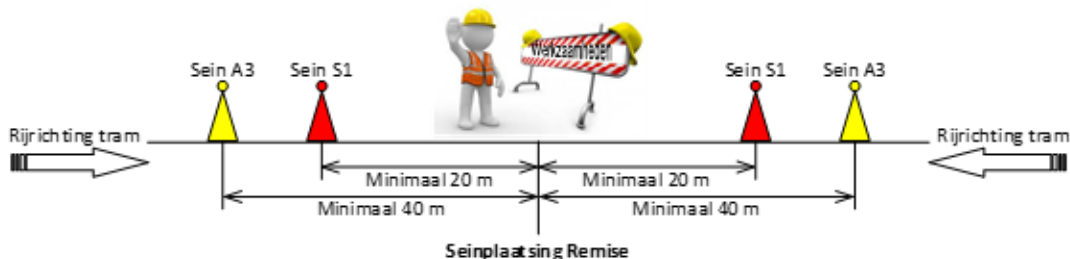
Figuur 5 – voorbeeld plaatsing seinen A-regime remise
