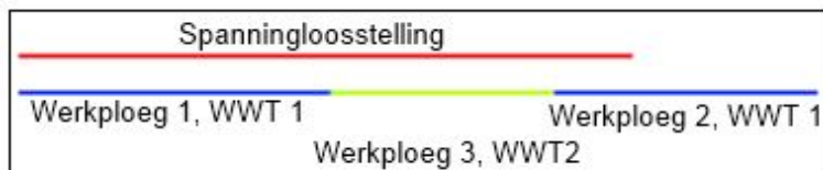
Figuur 4 - Meerdere werkploegen in gebied met spanningloosstelling
