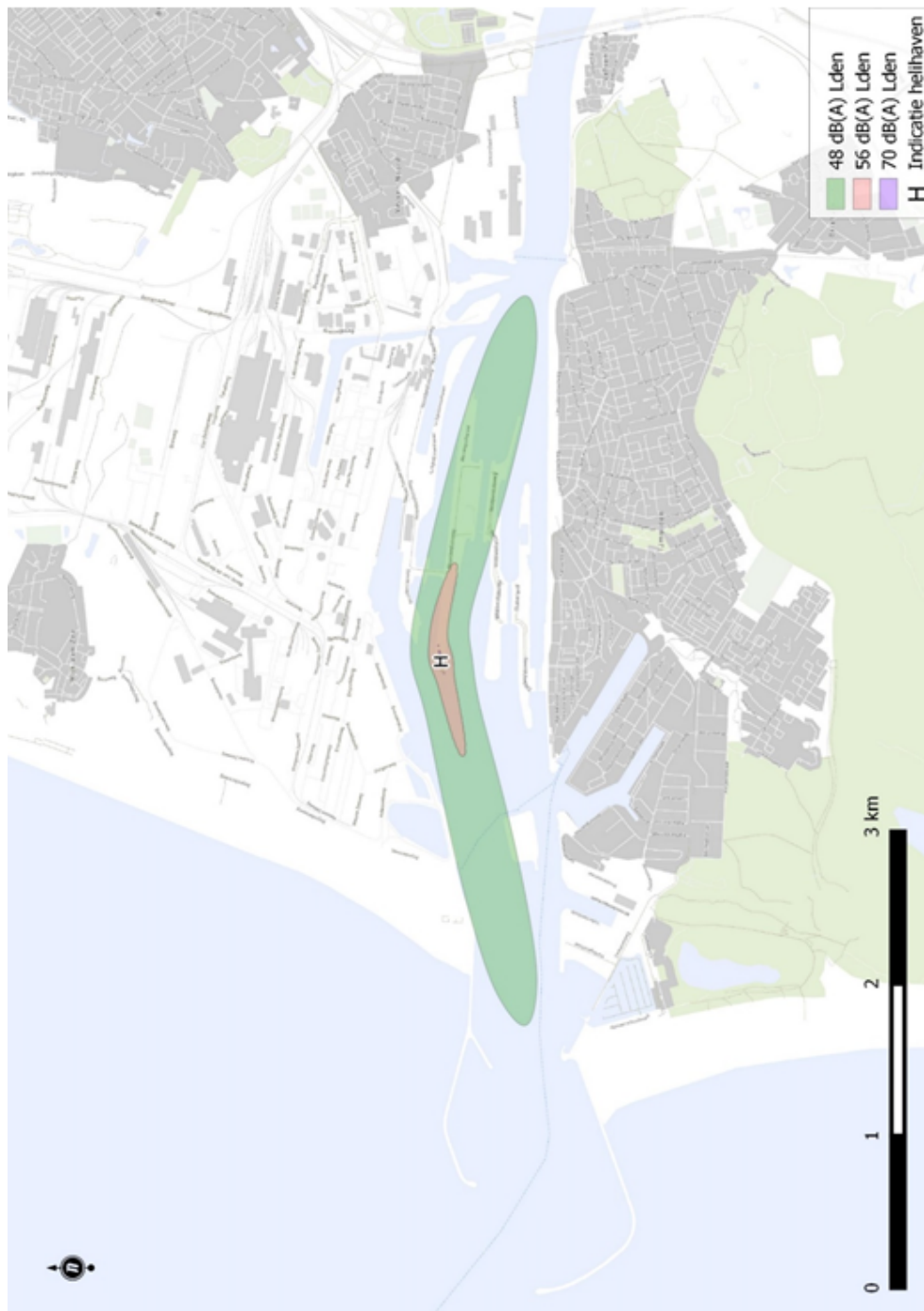
Geluidscontouren voor 48 dB(A) Lden, 56 dB(A) Lden en 70 dB(A) Lden voor 700 helikopterbewegingen bij een gelijkmatige verdeling van het verkeer over de aanwezige in- en uitvliegrichtingen (volledige uitsnede)
