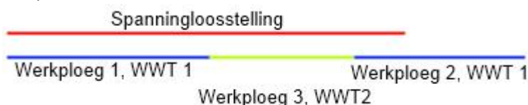
Figuur 4 - Meerdere werkploegen in gebied met spanningloosstelling
