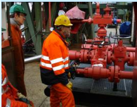
Boorinspecteur aan de choke om een ‘ingeswabte’ gaskick beheerst af te laten (foto: SodM)
