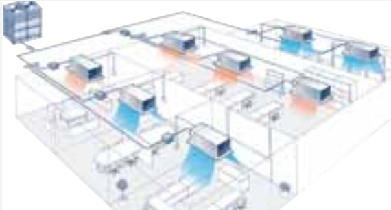
Overzicht van een VRV systeem met linksboven de centrale buitenunit (de koelmachine) en 8 binnenunits. De buitenunit staat buiten het gebouw. De binnenunits bevinden zich in de vertrekken.
