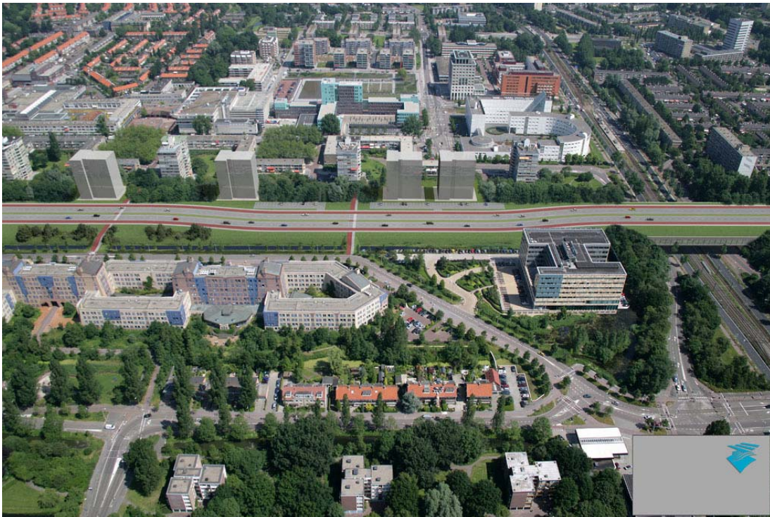
Figuur 2.24: visualisatie half verdiepte variant door Amstelveen, met de A9 onder maaiveld en het dak van de tunnel 3 meter boven maaiveld. Boven op het dak komt groen met een stadsstraat ter vervanging van de huidige aansluiting Amstelveen, met kruisende noord-zuidverbindingen en fietspaden. Langs de tunnelbak is indicatief stedelijke bebouwing aangegeven.
