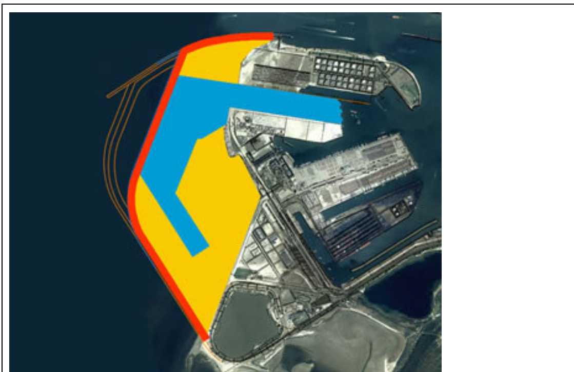
Figuur 8.5 Maasvlakte 2 Doorsteekvariant fase 1 (bron: Havenbedrijf Rotterdam NV) NB: Figuur geeft het meest actuele, openbare, ontwerp
