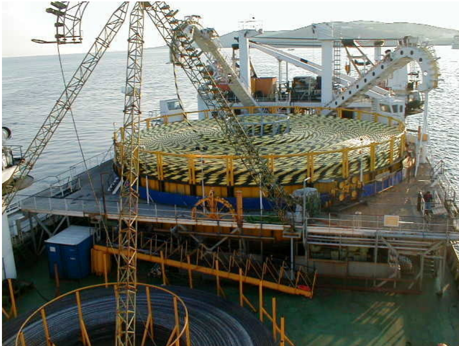
Foto 5.1 Zwaar kabellegschip met kabelcarrousel (bron: Metoc)
