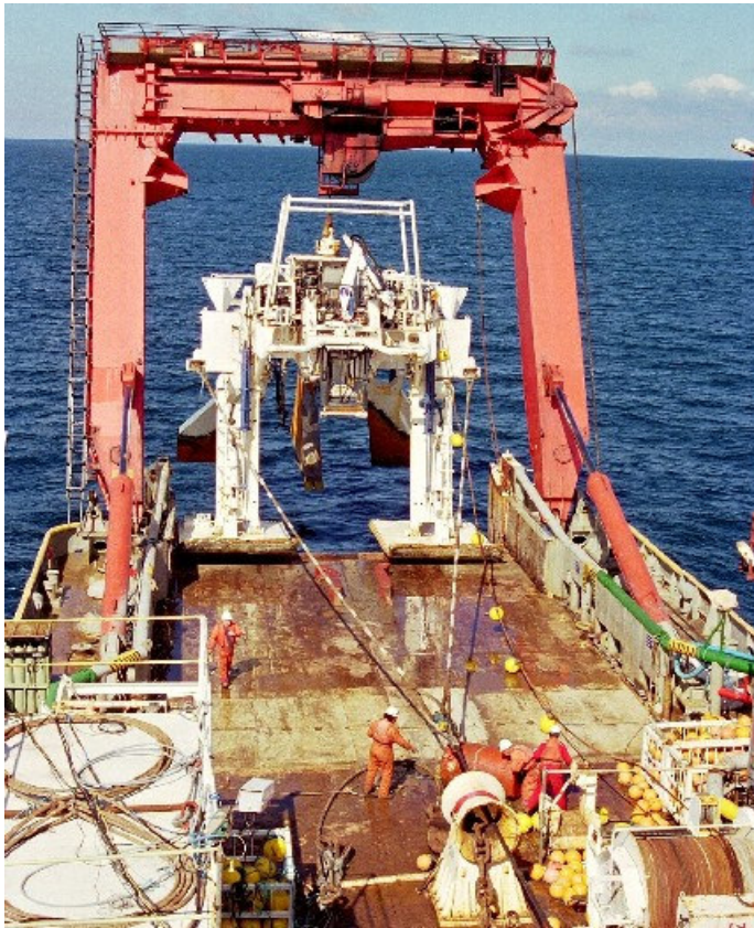
Foto 5.2 Een ploeg wordt te water gelaten vanaf het begeleidende schip (bron: Metoc)
