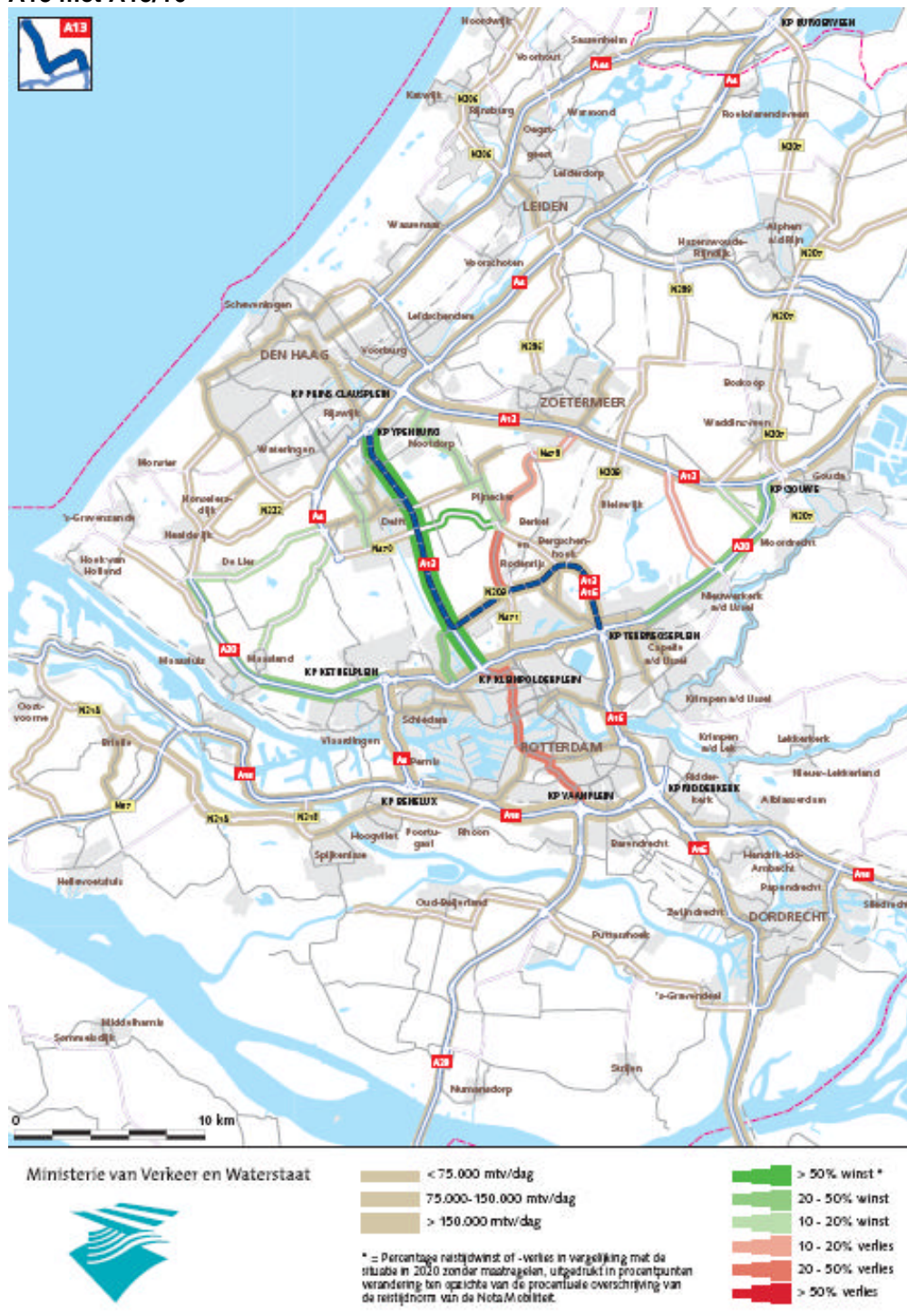
Kaart 3. Reistijdwinst en -verlies t.o.v. referentie van de oplossing Verbreding A13 met A13/16
