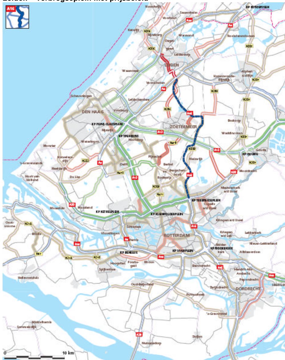
Kaart 11: Reistijdwinst en -verlies tov. referentie 2020 van de oplossing A16 Leiden – Terbregseplein met prijsbeleid
