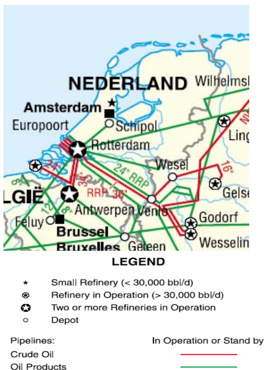
Figuur 3.1 Pijpleidingen voor olie- en olieproducten.
