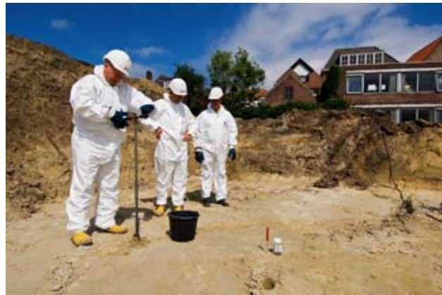
Foto 1: Bodemonderzoek op het gasfabriekterrein in Bergen op Zoom (foto: Gert van Mil)
