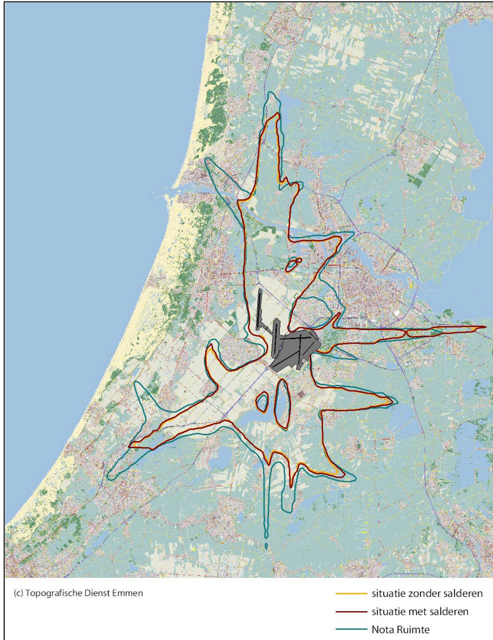
Figuur 2: 20 Ke-geluidscontour voor een mogelijke situatie met salderen ten opzichte van de situatie zonder salderen en de 20 Ke-contour uit de Nota Ruimte.
