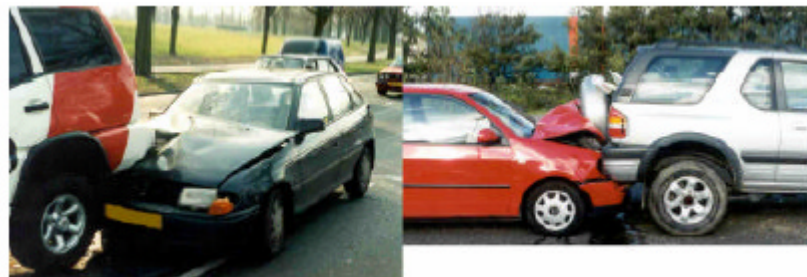
Figuur 2 : Schade a.g.v verschillen in bumperhoogte (BRON, TNO 2004)
