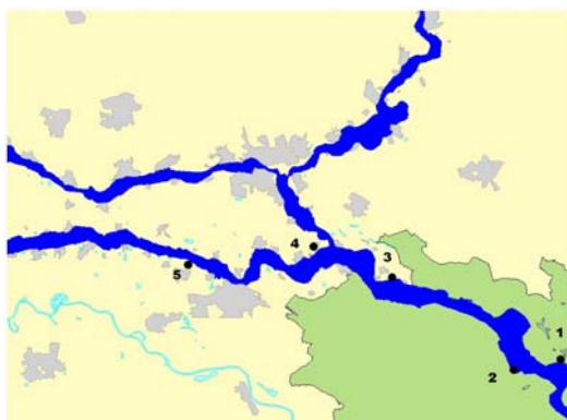
Figuur 5-1 Mogelijke doorbraaklocaties in geval van een bovenmaatgevende Rijnafvoer (1=Rees, 2=Kalkar, 3=Rijnstrangen, 4=Betuwe, 5=Land van Maas en Waal) (Vis et al., 2001).
