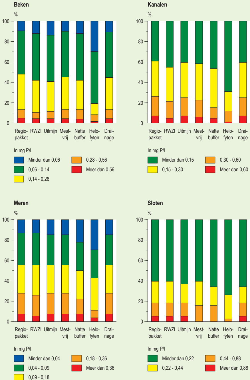
Figuur 4.13 Verwachte verandering fosforconcentraties in de regionale wateren (beken, meren, sloten, vaarten/kanalen) voor de beschouwde aanvullende varianten gericht op verdere vermindering van de nutriëntbelasting.
