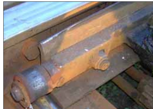
Afbeelding 10: Een scherpe kras geeft het begin van de ontsporing aan.
