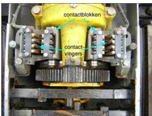
Afbeelding 15: Links de twee contactblokken in de stellerkast met de contactvingers. De acht contactvingers liggen tegen buitenste contacten van de contactblokken.
