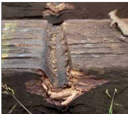
Afbeelding 7 & 8: Links een afdruk van het linker wiel en rechts van het rechter wiel van het achterste wielstel van de gekantelde (35°) wagon die het eerst ontspoorde.
