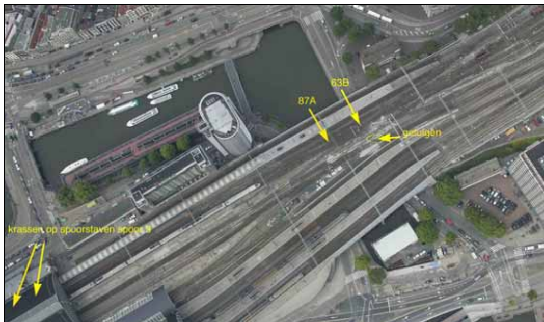
Afbeelding 20: Ter hoogte van wissel 87A zagen de getuigen vonken. De krassen op spoor 3a bevinden zich onder de overkapping.
