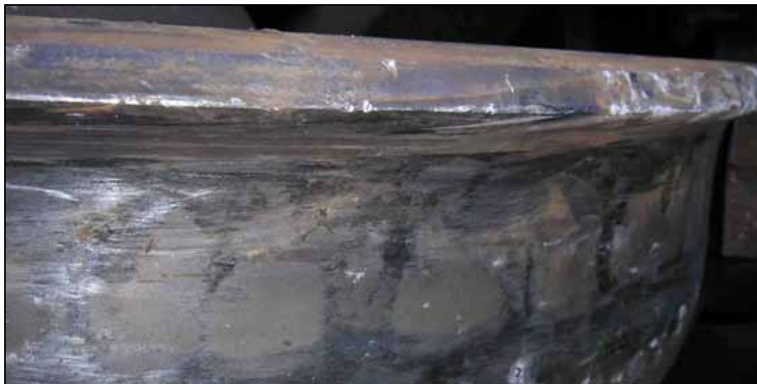
Afbeelding 6: De flens van het linker wiel van het achterste wielstel van de 35° wagon.
