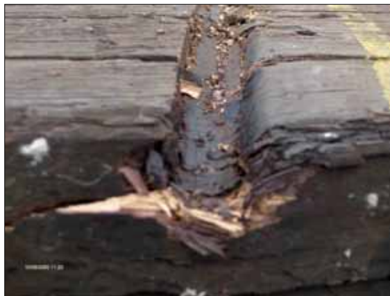
Afbeelding 7 & 8: Links een afdruk van het linker wiel en rechts van het rechter wiel van het achterste wielstel van de gekantelde (35°) wagon die het eerst ontspoorde.
