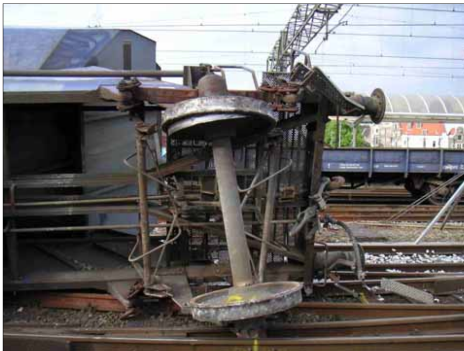
Afbeelding 8: Wagen 22 op rechterzijkant met losse wielband linksachter
