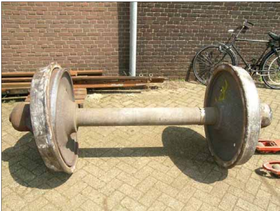
Afbeelding 9: Detail van losse wielband van achterste as van wagen 22 is afgevoerd voor nader onderzoek.
