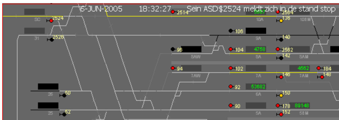
Afbeelding 5: Trein 53682 rijdt het emplacement op en passeert het inrijdsein 2524. Sein 2524 is uit de stand stop geweest en afgereden. De ingestelde rijweg is richting spoor 6a.
