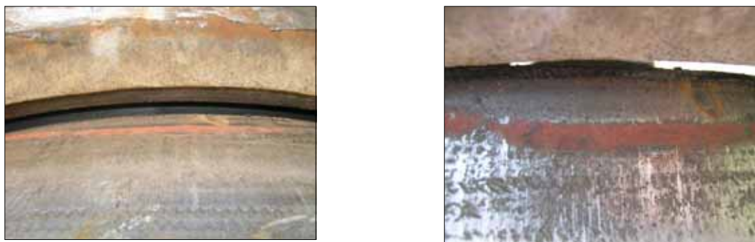
Afbeelding 10a/b : Detail van de losse wielband en het binnenwiel links van wagen 22 met markeringen van rode verf van de linker strijkregel bij wissel 2549. Duidelijk zijn markering te zien van rode verf ten gevolge van het raken van de linker strijkregel bij wissel 2549. De foto toont tevens dat het oppervlak van het binnenwiel waarom de wielband heeft gezeten glanzend metaal laat zien en geen roestsporen vertoont. Dit laatste duidt op het spontaan losschieten van de wielband.
