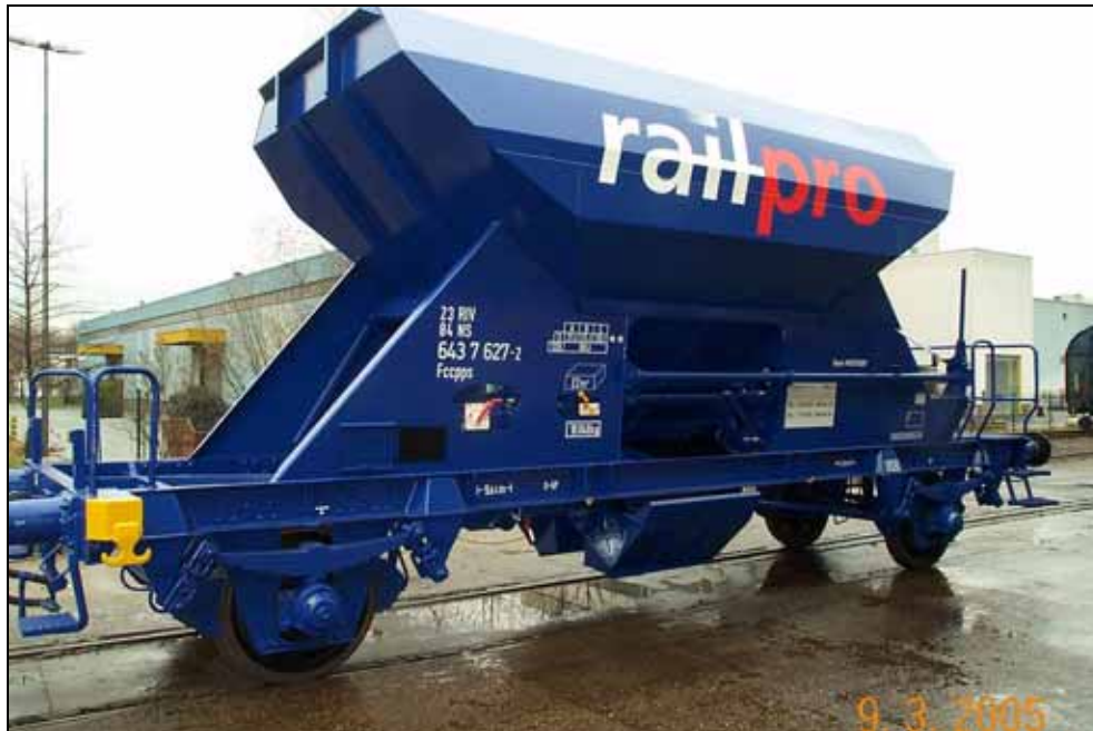
Afbeelding 2: Een goederenwagen van het type 'Fccpps' voor het transport van gebroken ballast
